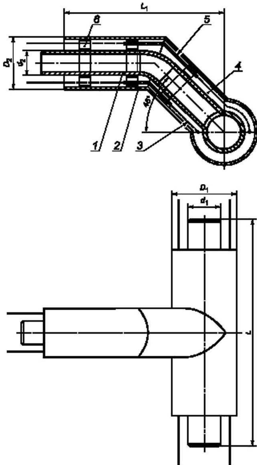
1 — стальной отвод; 2 — оболочка. 3 — проводник—индикатор системы ОДК; 4 — изоляция из пенополиуретана,
