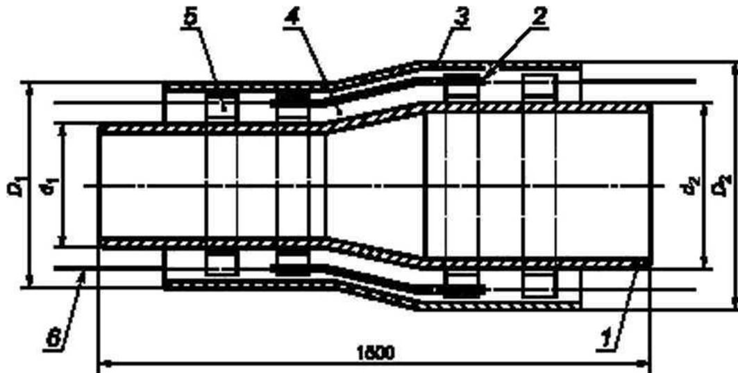
1 — стальная труба; 2 — электроизоляционная трубка (для труб со стальной оболочкой); 3 — оболочка; 4 — изоляция из ППУ; 5 — центрирующая опора; 6 — проводник—индикатор системы ОДК (показан условно)
