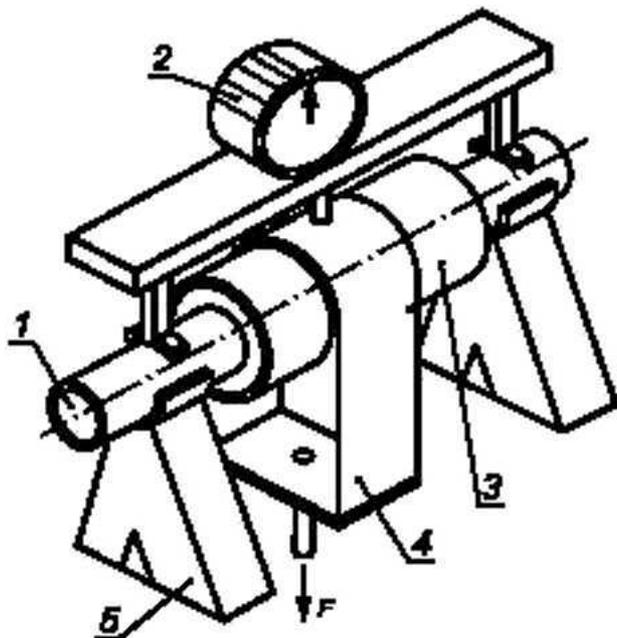
1 — стальная труба, 2 — индикатор; 3 — труба-оболочка из полиэтилена и изоляция из ППУ;
