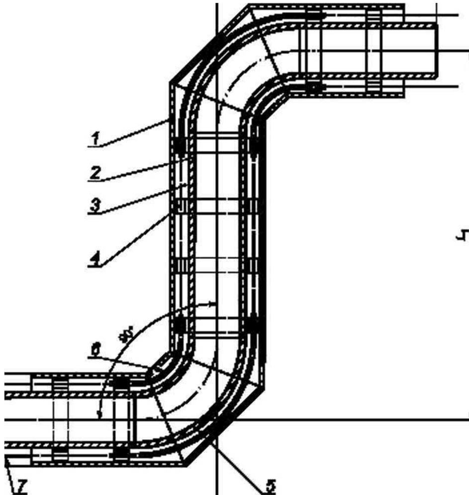
1 — оболочка. 2 — стальная труба; 3 — изоляция из ЛПУ; 4 — центрирующая опора. 5 — стальной отвод, 6 — электроизоляционная трубка (для труб со стальной оболочкой). 7 — проводник—индикатор СОДК
