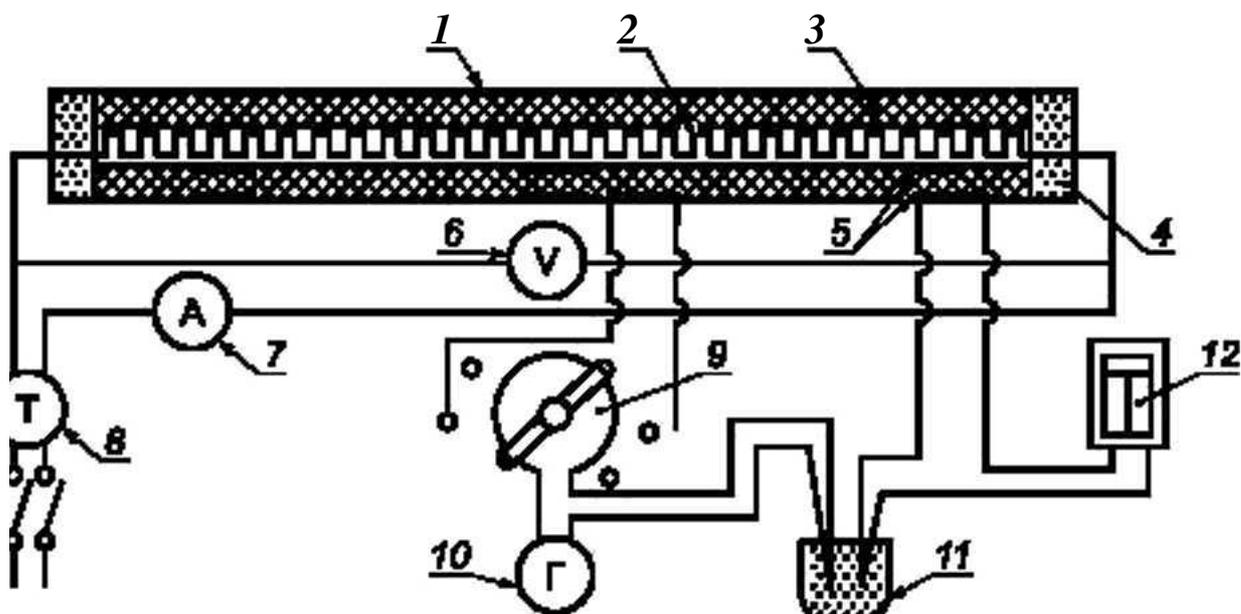
1 — стальная труба; 2 — электронагреватель; 3 — испытуемый материал; 4 — охранный секция; 5 — термопары
