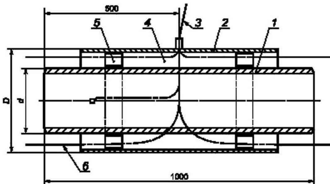
1 — стальная труба; 2 — оболочка; 3 — кабельный вывод; 4 — изоляция из ППУ; 5 — центрирующая опора;
