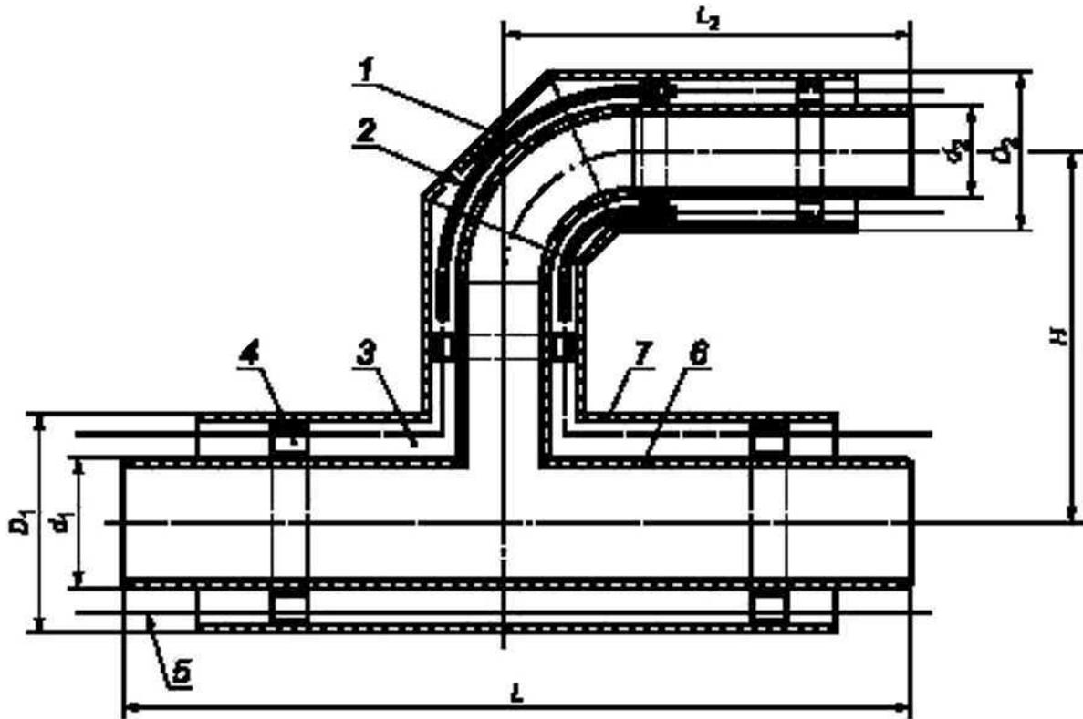
1 — стальной отвод; 2 — электроизоляционная трубка (для труб со стальной оболочкой); 3 — изоляция из ППУ; 4 — центрирующая опора; 5 — проводник— индикатор системы ОДК; 6 — стальная труба; 7 — оболочка
