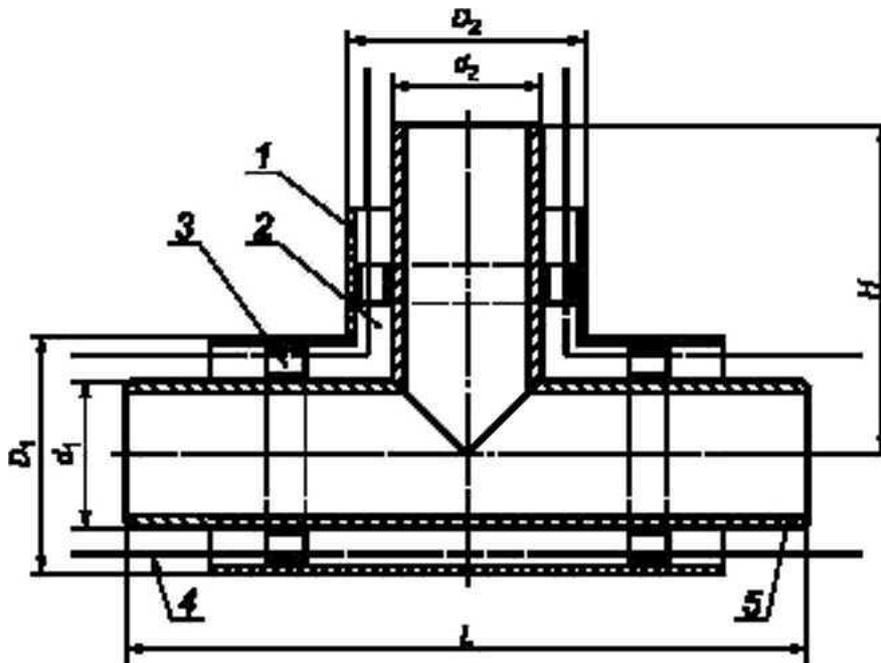
1 — оболочка; 2 — изоляция из пенополиуретана, 3 — центрирующая опора. 4 — проводник— индикатор системы ОДК;
