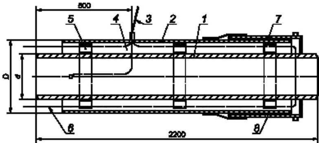
1 — стальная труба; 2 — оболочка ка. 3 — кабельным вывод; 4 — изоляция из ППУ. 5 — центрирующая опора. 6 — проводник—индикатор СОДК. 7 — металлическая заглушка изоляции. S — герметик (термоусадочное полотно)
