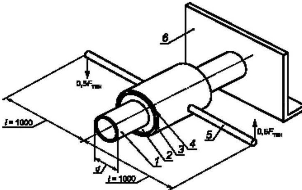
1 — стальная труба. 2 — изоляция из ППУ. 3 — труба оболочка из полиэтилена; 4 — хомуток. 5 — рычаг. 6 — неподвижная опора
