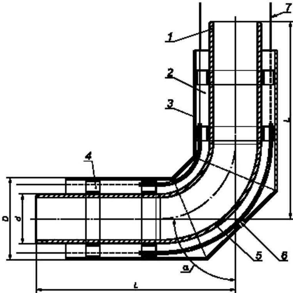
1 — стальная труба; 2 — изоляция из ППУ; 3 — оболочка; 4 — центрирующая опора. 5 — стальной отвод; 6 — электро-
